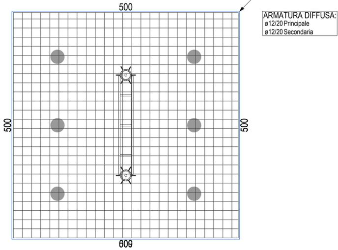
PLATEA SP. 25 CM Rck 300 armata con ferri Ø12/20" sopra e sotto
